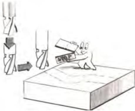
Dalam menyusun program CNC, titik awal program untuk alat potong seha-rusnya juga menjadi titik akhir dari pro-gram. Untuk mudahnya, titik pengganti-an alat potong juga merupakan titik awal alat potong. Oleh karena itu, goreskan atau sentuhkan permukaan referensi de-ngan menggerakkan alat potong (pisau frais), lalu jauhkan alat potong pada ja-rak yang aman dari benda kerja, se-hingga puncak mata alat potong berada di titik awal yang dipilih.
