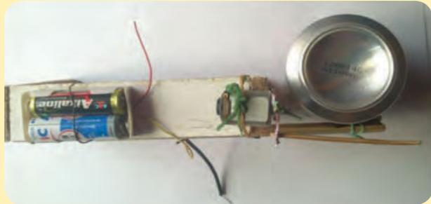
11. Sambungkan salah satu kabel dari baterai ke saklar, sedangkan kabel yang satunya lagi ke Motor Listrik DC. Kemudian ambil satu kabel tambahan yang digunakan untuk menghubungkan Motor Listrik DC dengan saklar.
