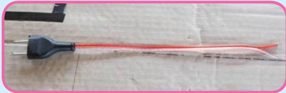
4. Siapkan lagi kabel serabut (warna merah putih), kemudian potong dengan panjang 4 cm sebanyak 3 potong dan pisah kabel merah dengan kabel putih menggunakan pisau atau cutter.
