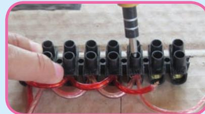
12. Pasang ujung kabel merah di terminal pembagi pada lubang nomor 7 dan kencangkan bautnya.
