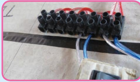
24. Masukkan ujung kabel dari terminal dan sakelar ke lubang kardus/dos yang sudah disiapkan (lubang di bawah sakelar), kemudian munculkan kembali ke permukaan kardus/dos di lubang posisi *stand* lampu.
