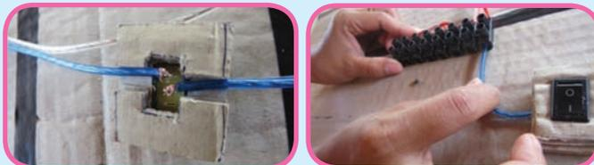
23. Pasang ujung kabel putih ke terminal pembagi arus dan kencangkan bautnya (lubang nomor 2).
