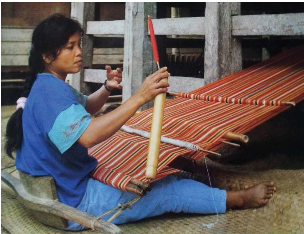
Gambar 1.32 Alat Tenun Gendong dengan benang lungsin yang terputus
