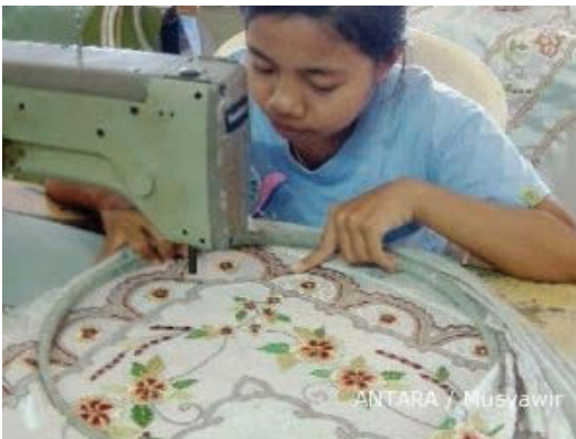
Gambar 1.49 Teknik bordir dengan menggunakan mesin jahit
