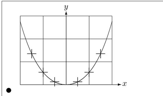
En esta figura, cada mitad simétrica de la catenaria  $y = \cosh x - 1$  se aproxima mediante una curva de Bézier cuadrática. La mitad derecha de
