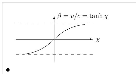
Los puntos de control de las dos curvas de Bézier se calcularon con las fórmulas (5.1). La rama positiva se determina con  $P_1 = (0; 0)$ ,  $m_1 = 1$  y  $P_2 = (2; \tanh 2)$ ,  $m_2 = 1/\cosh^2 2$ . De nuevo, el dibujo se define en coordenadas matemáticas convenientes, y a la esquina inferior izquierda se le asignan las coordenadas matemáticas  $(-3; -2)$  (círculo negro).
