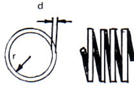
Gambar 1-7. Induktor gulungan tunggal
