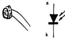
Gambar 3-3. Bentuk dan simbol dari dioda foto
