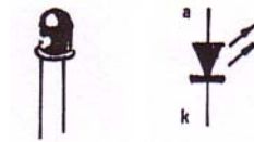
Gambar 3-4. Bentuk dan simbol dari dioda LED
